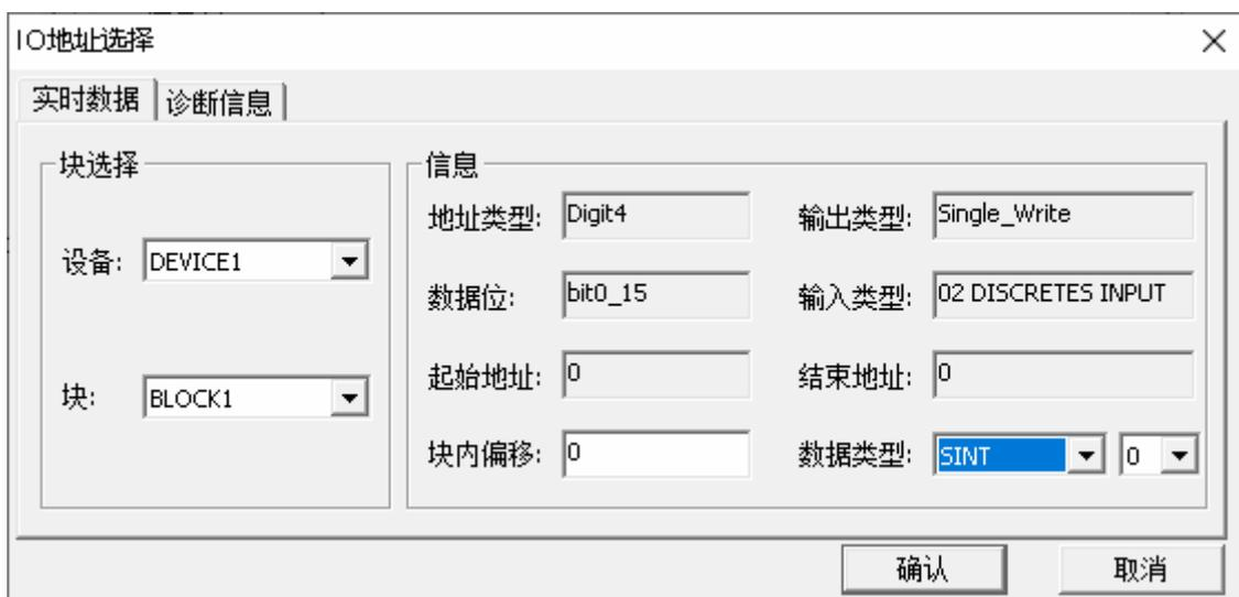
图 5-5 IO 地址设置 (ModbusTCP 驱动)
