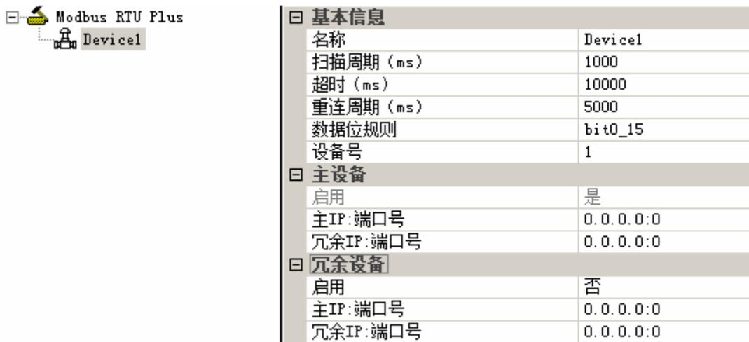
图 20-2 设备参数配置
