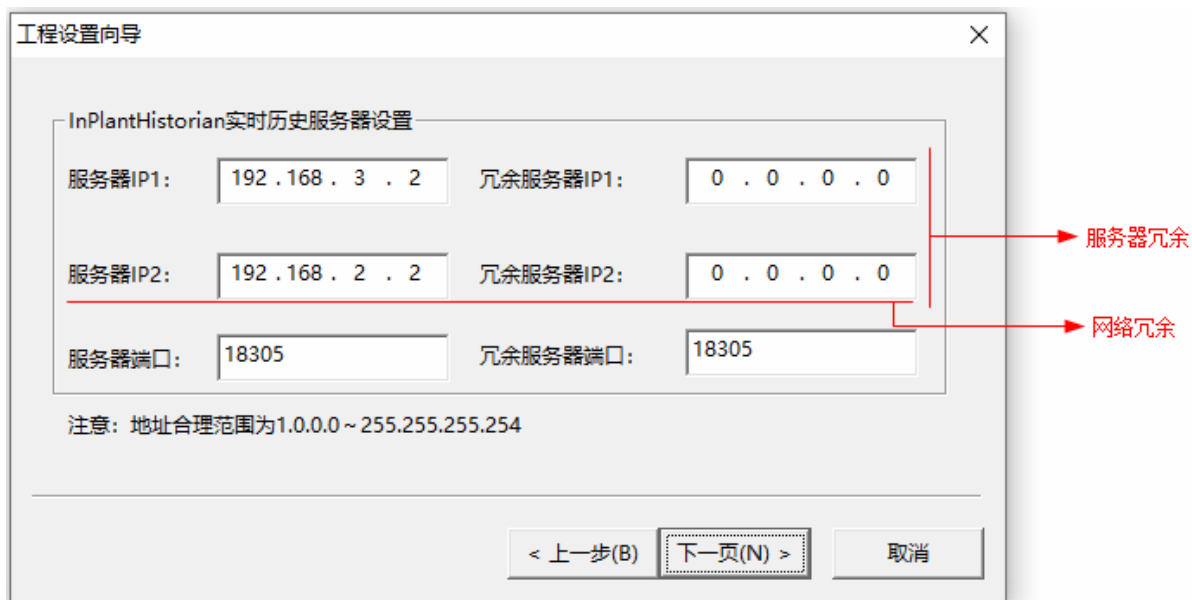
图 5-3 设置大型数据库服务器 IP
