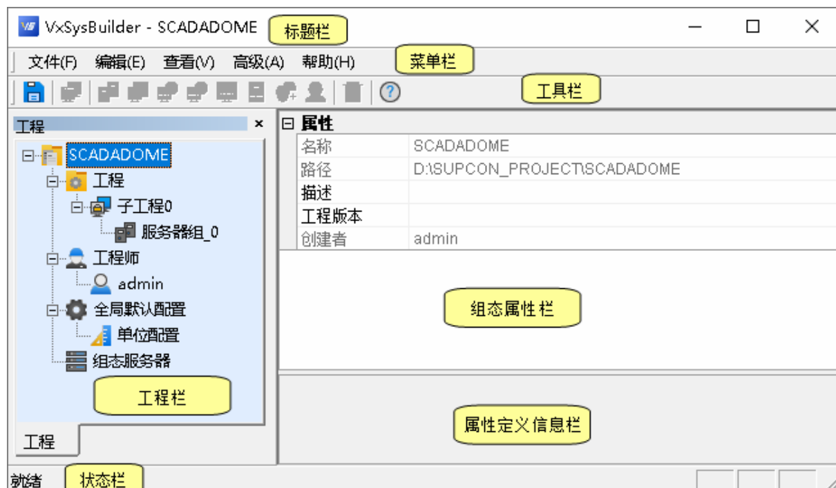
图 2-1 系统结构组态软件主界面
